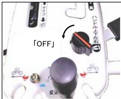
①主クラッチレバーから手を離し、エンジンスイッチを「停止(OFF)」位置にしてエンジンを停止して下さい。
