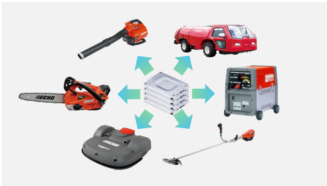
リユース EV バッテリーを活用した移動型バッテリー充電システム
