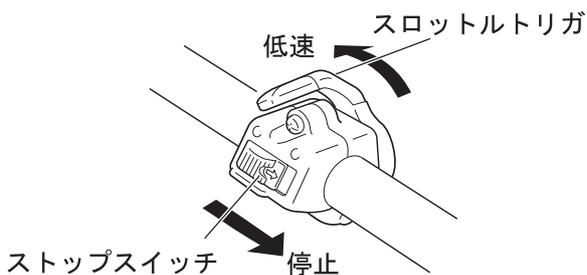
1. スロットルトリガを低速の位置にし、エンジンをアイドリング（低速運転）状態にしてください。
