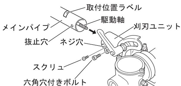
1. 刈刃ユニットのスクリュを取り外し、六角穴付きボルトをゆるめます。
