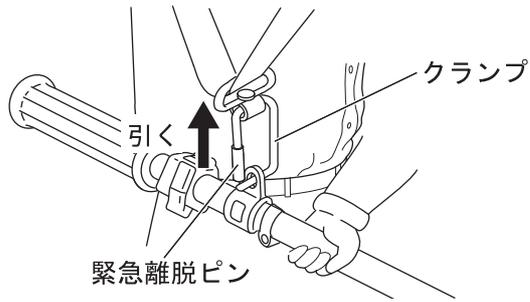
6. 肩掛けバンドには緊急離脱装置が付いています。火災など緊急の場合は緊急離脱ピンを上引き、製品を体から離してください。
