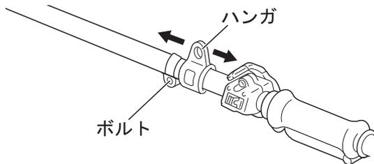
ハンガのボルトをゆるめ、ハンガを前後に移動して、ギヤケースが地面と水平になるように調整し固定してください。
