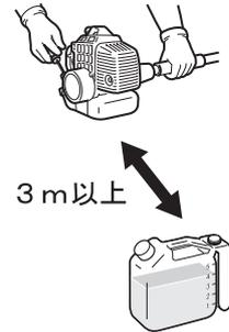
○ エンジンの排気ガスには、有毒なガスが含まれています。屋内など通気の悪い場所で製品を運転しないでください。
