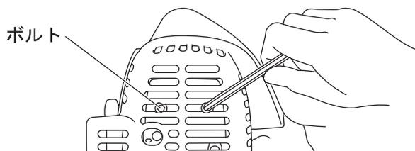
1. マフラの締め付けボルトにゆるみがないか確認してください。ゆるみがある場合は、付属の六角レンチで増し締めをしてください。
