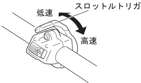
1. エンジン始動後スロットルトリガを高速の位置にスライドさせると、エンジンの回転数が上がり刈刃が動き始めます。刈り込む雑草や生垣などの量によって、回転数を調節してください。
