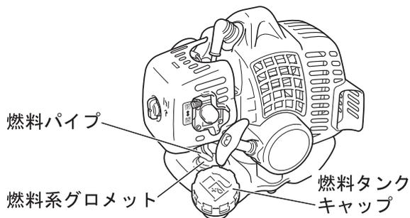
1. 燃料を補給した後、燃料タンクキャップを確実に締め付け、燃料パイプ、燃料系グロメット、燃料タンクキャップ周辺から燃料の漏れ、にじみがないことを確認してください。
