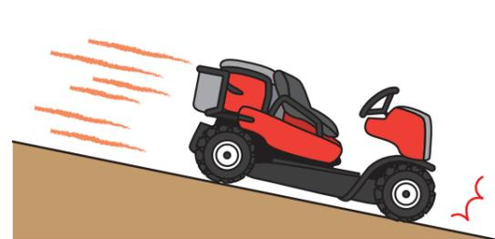
坂道を下るときは十分に速度を落とし、変速レバー・クラッチレバー類の不要な操作は行わないでください。
