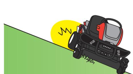
傾斜地では等高線方向で作業してください。作業傾斜角度を超える使用は本機が横転して機械の下敷きになる恐れがあり、大変危険です。
