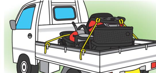
駐車ブレーキをかけて、製品は十分に強度のあるロープで確実に固定してください。
