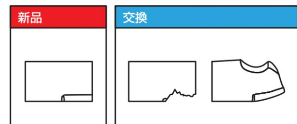
ナイフにヒビ、割れ、摩耗が無い点検をしてください。交換の際には必ず純正部品を使用してください。
