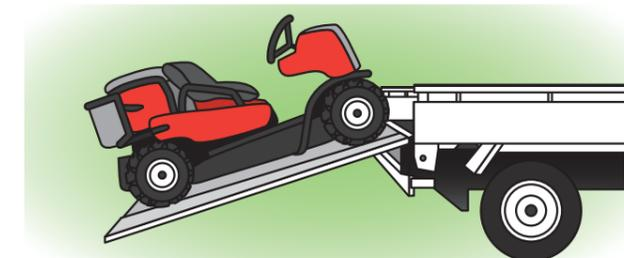
ブリッジは十分な強度と幅を持った物を使用してください。デフロックレバーは必ず「入」位置にしてブリッジ上で操作しないでください。
