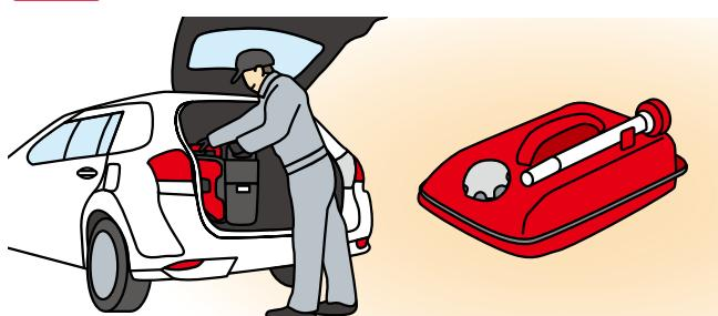
火災防止のため、燃料タンクから燃料を抜き、抜いた燃料や予備の燃料は、消防法に適合した携行タンクで保管・運搬してください。
