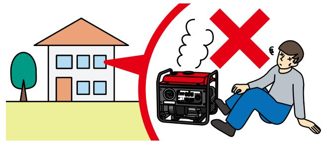
エンジンの排気ガス中には、人体に有害な一酸化炭素が含まれていますので、室内・トンネル・くぼ地などの換気の悪い所では運転しないでください。
