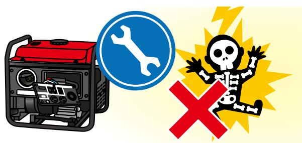
運転中は、配線や電気部品に電圧が発生しており、触れると感電する恐れがあります。また、機器の損傷させることができます。
