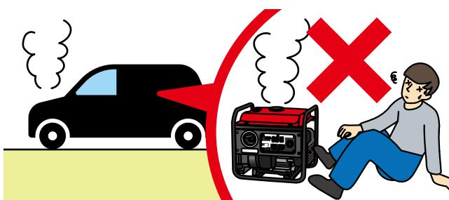
車両に積載したまま運転されると、排気ガスが充満したり、排気の熱で車両を損焼させたりする事故につながることがあります。
