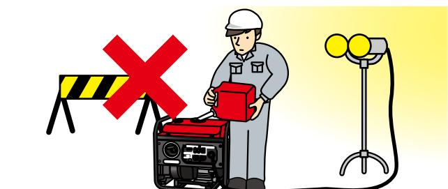
火災防止のため、燃料は、所定のレベル（燃料タンク給油口こし網の赤リング上面）以上給油せず、また、燃料をこぼしたときは、必ずふき取ってください。
