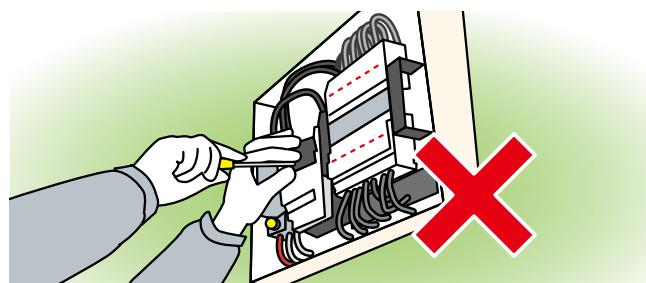
電気会社の屋内・電気配線への接続は法律で禁止されています。使用機器、発動機の故障や、火災、感電事故を発生させることができます。
