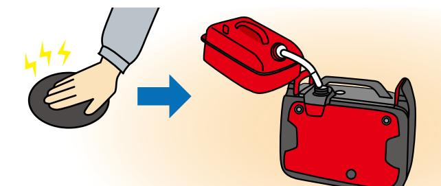
燃料の点検や給油・抜取り・燃料ストレーナーの清掃などを行うときは静電気を除去して、必ずエンジンを停止し絶対に火気を近づけないでください。
