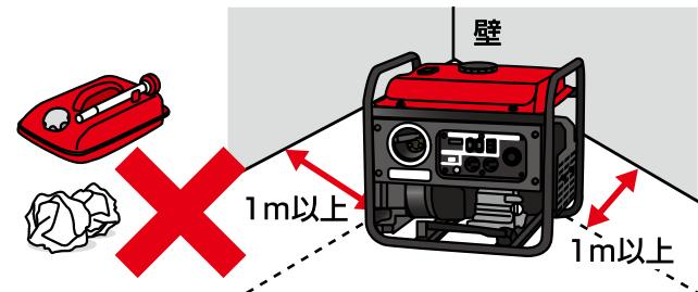
火災防止のため、壁などの障害物から 1 m以上離し、水平な場所で運転してください。引火性のある燃料や可燃物などは、本機に近づけないでください。
