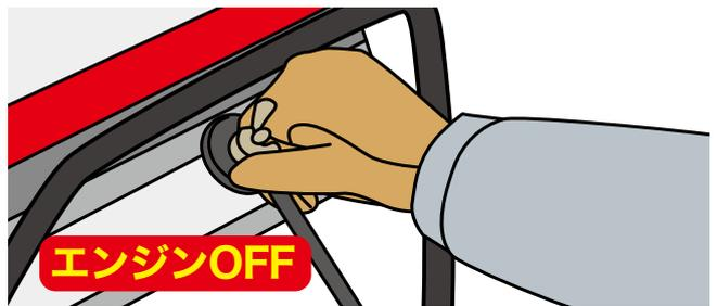
溶接ケーブルの取り付け・取り外しは、エンジンを停止して行ってください。溶接ケーブルは適正断面積以上の物を使用し、接続は確実に行ってください。
