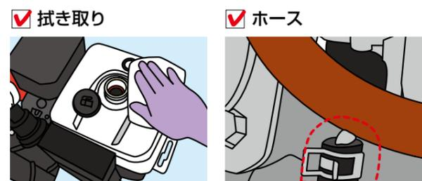
給油はエンジンが十分に冷えてから行ってください。給油中にこぼれた燃料は必ずふき取ります。また、燃料ホース等に漏れがないか点検をしてください。
