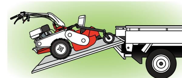
ブリッジは十分な強度と幅を持った物を使用してください。積み下ろし時は、サイドクラッチや変速レバー、走行クラッチの操作は行わないでください。
