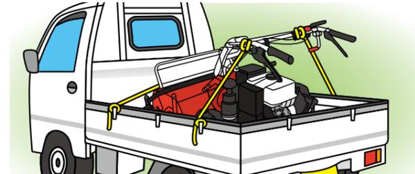
製品の運搬時は駐車ブレーキをかけて、製品は十分に強度のあるロープで確実に固定してください。
