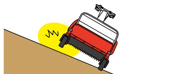
傾斜地での作業はあらかじめ取扱説明書を確認し、転倒などに十分注意して行ってください。作業角度を超える傾斜での使用は大変危険です。
