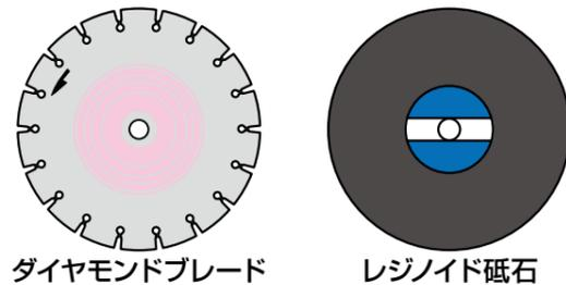
純正の刃物・砥石以外は使用しないでください。切断材料に適した刃物の選定をしてください。砥石の側面は使用しないでください。
