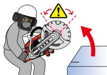
刃物の上半分で切断すると刃物の先端が反動で跳ね上がり危険ですので刃物の下半分で切断してください。切断中に刃物が挟まれないように注意してください。
