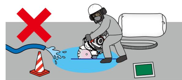
集塵式製品で湿式切断をすると集塵ファン部のベアリングが損傷します。鑄鉄管を切断すると集塵ファンの異常摩耗や高温切粉によるホース穴開きが起きます。
