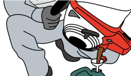
長期間使用しないときは燃料タンク・気化器内部を空にしてください。燃料が残っていると変質して故障の原因になります。
