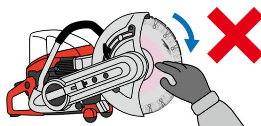
機械の運転中やエンジン停止後、刃物が回っている間は刃物に触れないでください。
