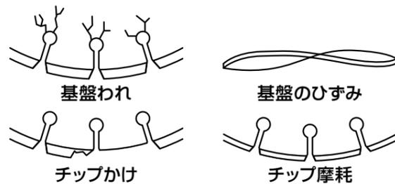
ひび割れ、欠け、曲がりや異常摩耗があるダイヤモンドブレード・砥石や、運転時に、異常振動や異常音がある場合は使用しないでください。
