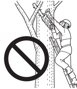
はしごを使用した作業は危険です
