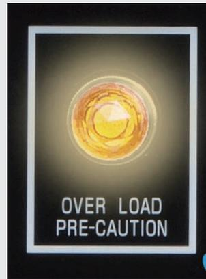
L1、L2、L3からの三相出力はモニターされており、いずれかが8定格の80%を超えたら警告ランプが点滅し、負荷の調整が必要なことを知らせます。
