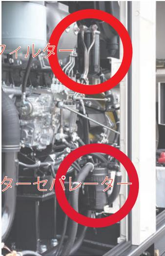
燃料システムは、通常の燃料フィルターに加え、プレフィルター機能付きウォーターセパレーターで構成されています。この二つのフィルターによって燃料から水や不純物を除去するので、メンテナンスが容易です。
