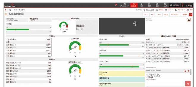
*写真は発電機の遠隔監視中のモニター画面です
